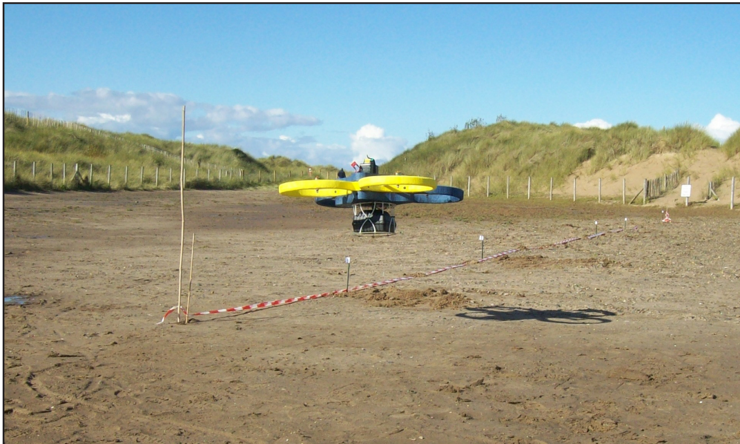
2. Разработанная с учетом потребностей заказчика антенна FLB500 установлена на квадрокоптер
