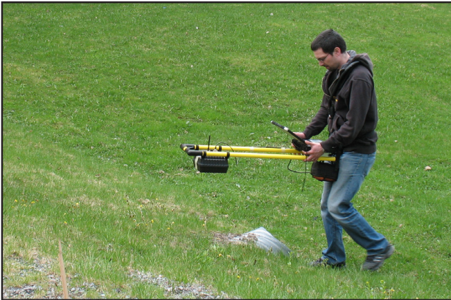
1. FLB500 установлен на крепёжное устройство при неровной местности
