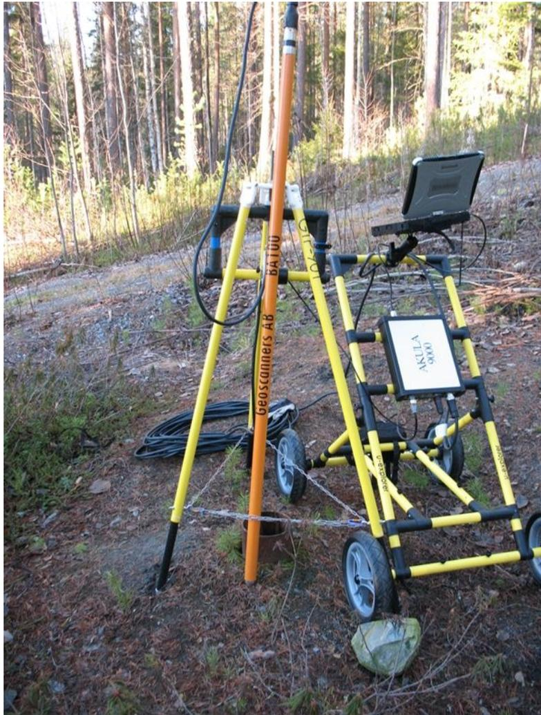
Установка геофизического исследования в скважине: VA100 со штативом измерения расстояния
